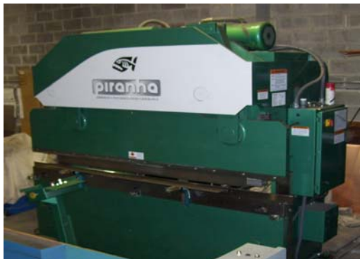
80 TON 8FT. BREAK
